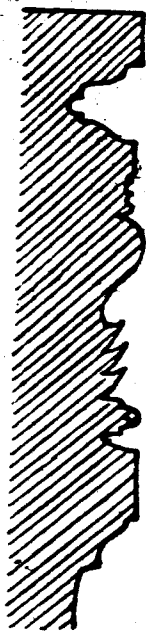
Fig. 18. Moulure de baie des monuments d'Ankor. Profil-type.
